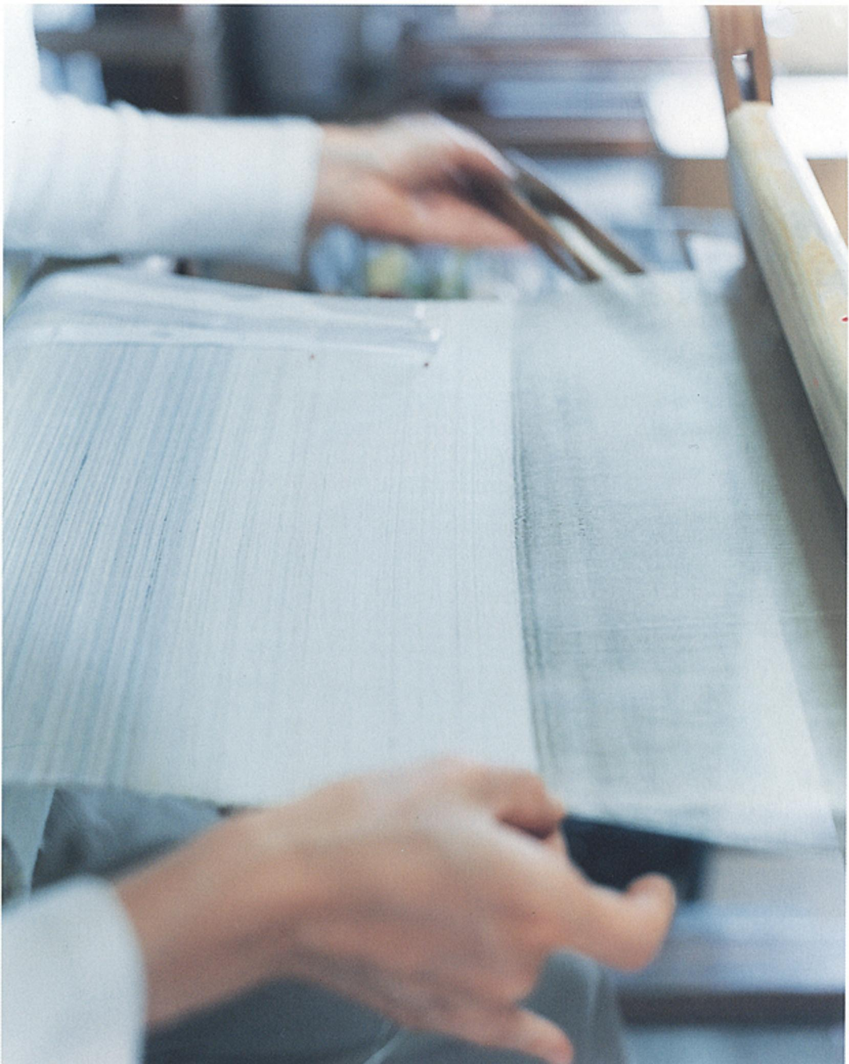
糸を染めたら、整経という経糸(たていと)づくりをして機にセットし、それから設計図に沿って緯糸を揃える。そうしてはじめて織り始めることができるのだ。杼(ひとと)呼ばれる道具で緯糸を左右に飛ばしながら、着実に織り進めていく。
